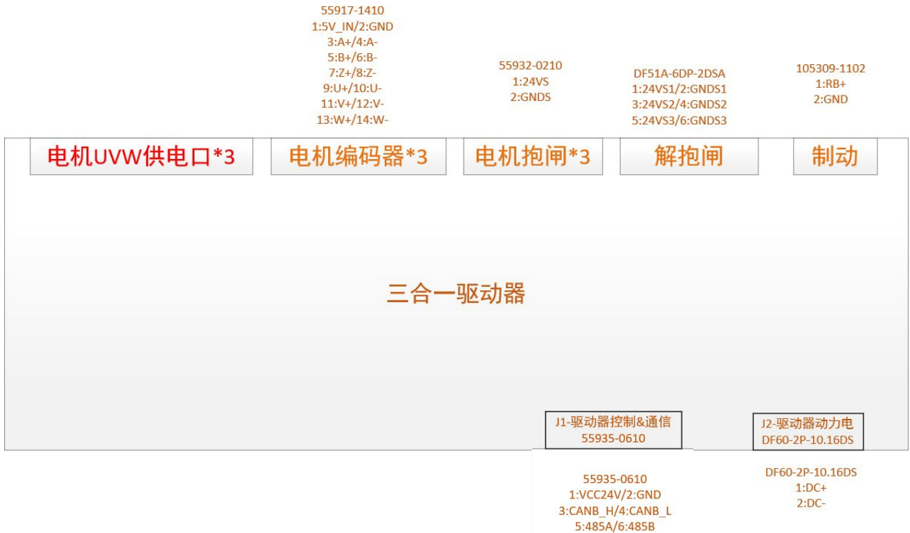
图 2: 驱动器连接器型号及 PIN 定义
