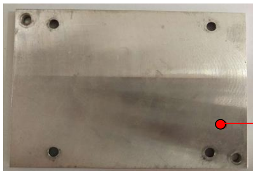
图 4. 导热片厚 2mm
