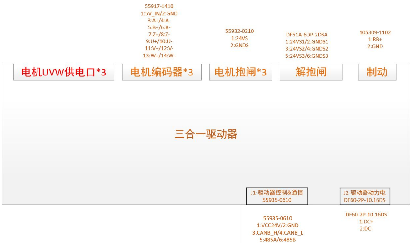
图 2: 驱动器连接器型号及 PIN 定义
